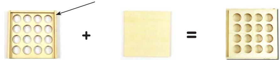
En parallèle, assembler les éléments de la boîte **A** à en appliquant de la colle aux points de jonctions
